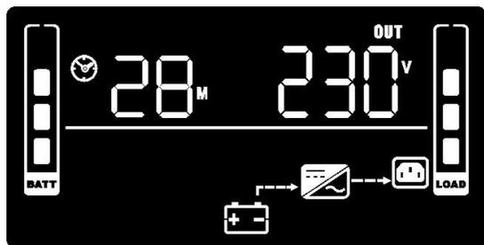
Figura 16: Display funzionamento a batteria
