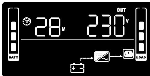
Figura 16: Display funzionamento a batteria
